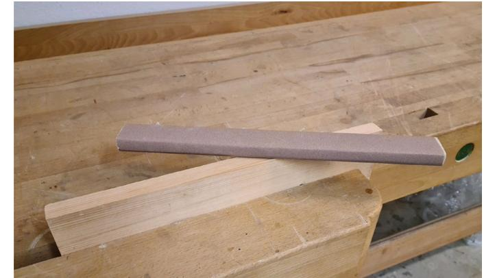
Abb.: Slippix – der Schleifstab (Penning/Glugla/Gulich)
