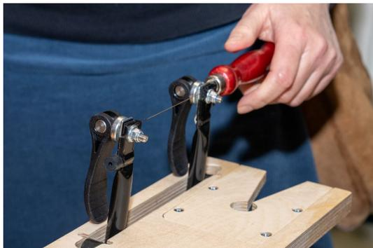
Abb.: Vorrichtung zum Einspannen der Laubsäge beim Wechseln des Sägeblattes (van Dongen)
