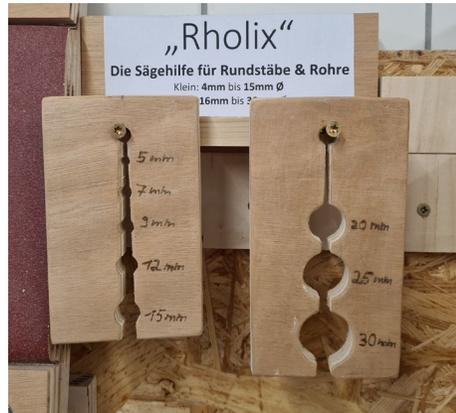
Abb.: Rholix – die Sägehilfe für Rundstäbe & Rohre (Heinevetter)
