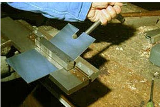
In einer kleinen Biegevorrichtung, die eigens für dieses Werkstück hergestellt werden muss, wird das U-Profil gebogen. Ein Druckbalken fixiert das Blech und der 90 mm lange Schenkel wird rechtwinklig gebogen. 4
