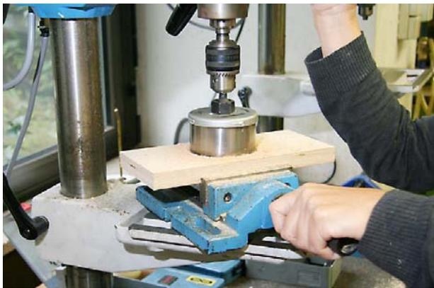
Die senkrechte Platte bekommt die Bohrung für das Uhrwerk. Wir benutzen hierzu eine Lochkreissäge mit festem Sägeblatt. Sägeblätter, die in vorhandene Nuten im Bohrkopf eingehakt werden, sind ungeeignet.
