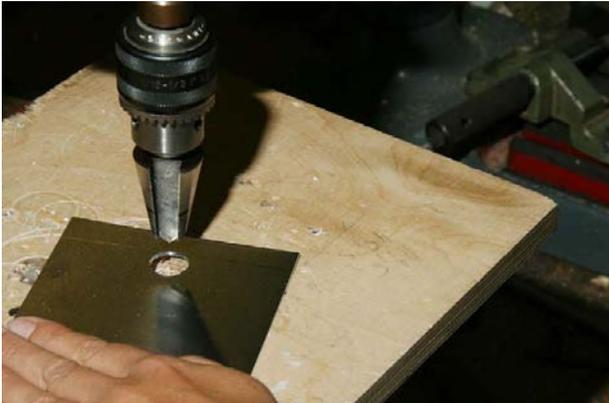
Die Schrägablage für die Notizzettel wird aus 1,5 mm dickem Alu-Blech gefertigt. Um ein U-Profil zu biegen, das später seitlich mit einem Leistenprofil geschlossen wird, muss zunächst ein Griffloch gebohrt werden. Hierzu benutzen wir einen konischen Blechbohrer, der gefahrlos je nach Eindringtiefe die Bohrung herstellt. 1
