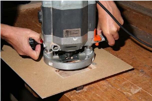
Im Bild links sieht man den Fräsvorgang. Unter der Abtastschablone liegt das Werkstück (oberes Foto). Die Abtastschablone ist um den Betrag größer, der sich aus der Differenz zwischen Fräserdurchmesser und Anlauftring ergibt. 10
