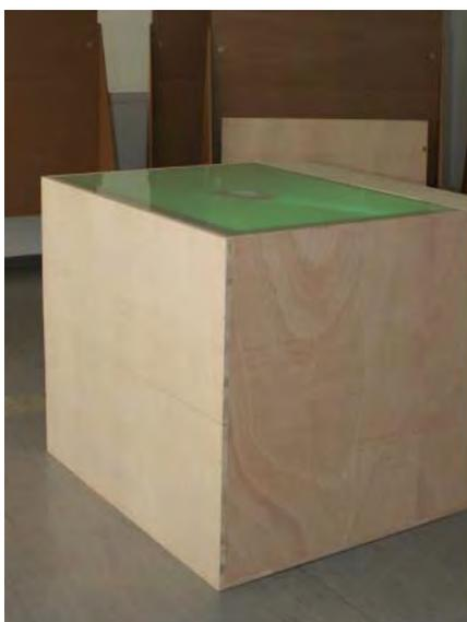
Ein Multi-Touch-Tisch nach dem DI-Verfahren wurde als Arbeitswerkzeug für Masterarbeiten im Fachbereich Kognitionspsychologie und Kognitive Ergonomie von mir an der TU Berlin erstellt (siehe Abb. 7 und 8). In der Holzwerkstatt der Arbeitslehre wurden der Holzkasten sowie die Halterungen für Beamer und Spiegel angefertigt.
