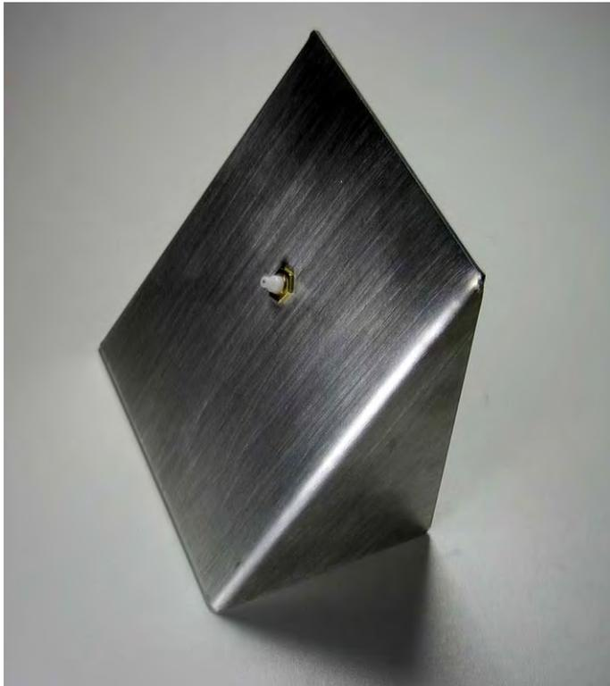
Im Bild links sieht man das fertig abgekantete Uhrengehäuse. In diesem Falle wurde keine Gravur (Firmenlogo) angebracht.
