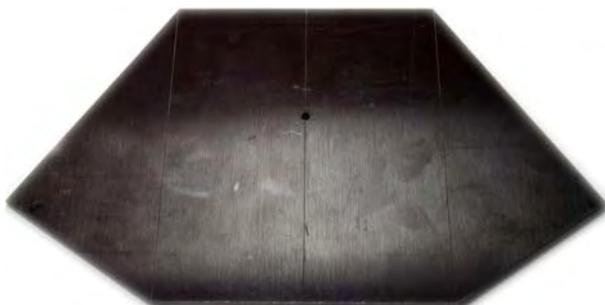
Eine Anreißschablone aus 4mm dickem Pertinax entspricht der Abwicklung des Aluminiumblechs (zwei Trapeze). Die Schablone deckt genau das Alublech (250 x 150 mm) ab.
