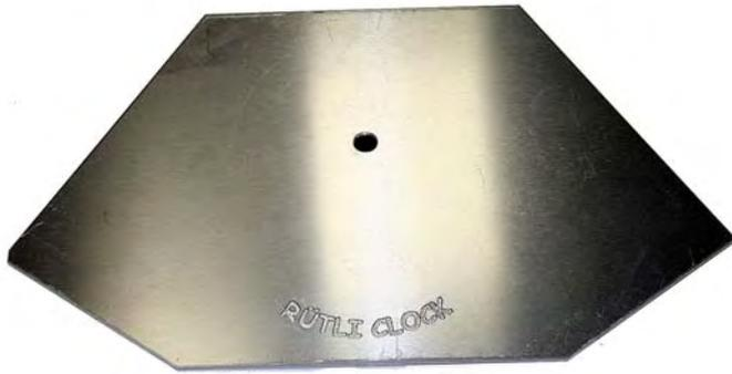
Das Alu-Blech hat jetzt seine endgültige Form an der Tafelschere bekommen. Die Bohrung für die Zeigerachse ist angebracht. Falls eine Gravur (ISEL-Maschine) erwünscht ist, muss diese natürlich vor dem Abkanten erfolgen.
