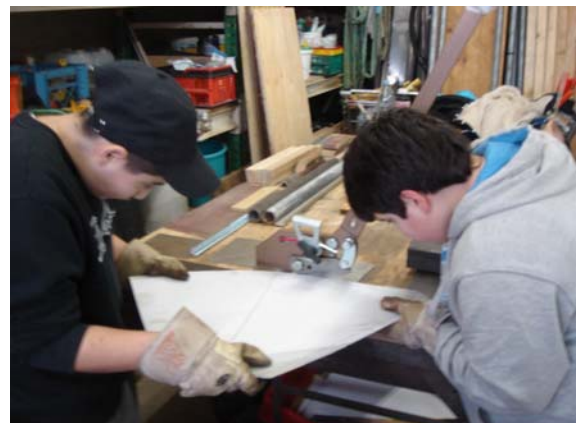
Das Blech für die „Flüstertüte“ wird zugeschnitten
