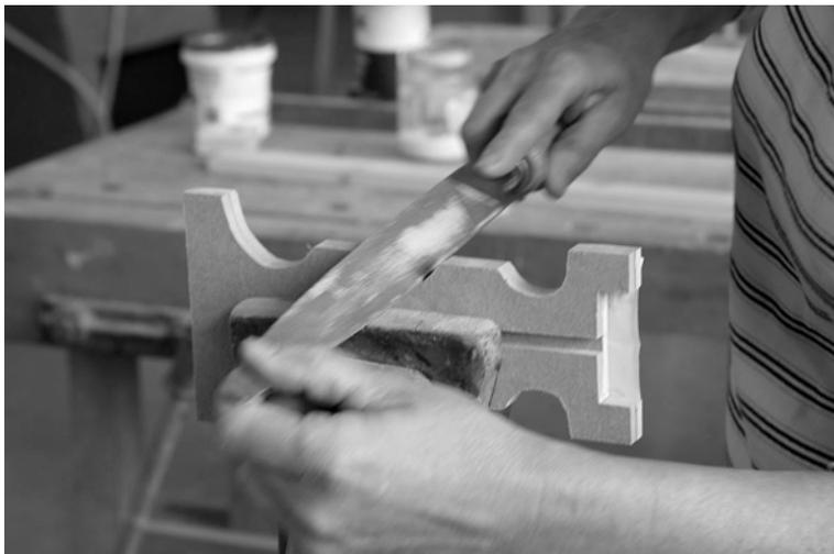
In der Regel erfolgt die Nachbearbeitung mit einer Feile, besser mit Formhölzern, über die Schleifpapier gespannt ist.
