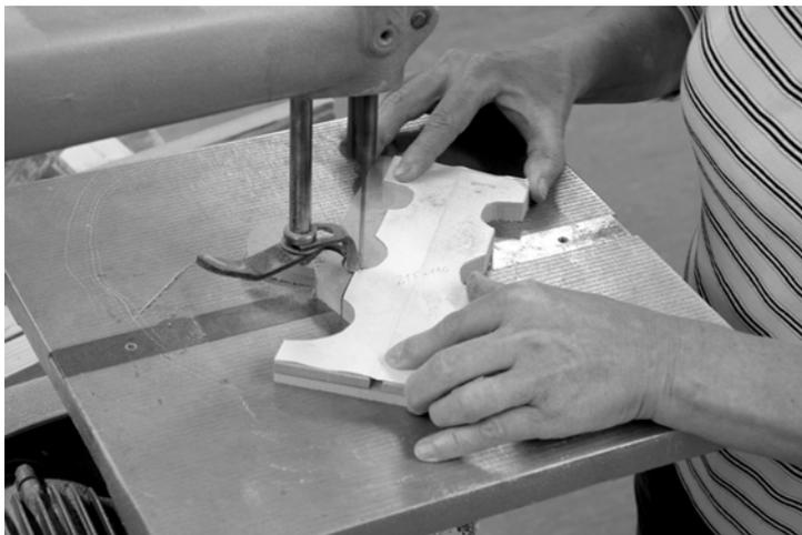
Die in der Mitte gefaltete Papierschaablone wird sorgfältig ausgeschnitten und nach dem Aufklappen mit wenig Leim auf den Platten fixiert. Diese können mit feinen Drahtstiften oder mit doppelseitigem Klebeband zuvor verbunden werden.
