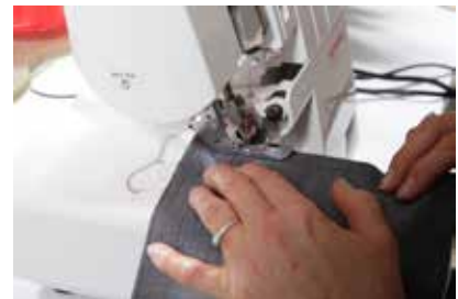
Versäubern der Stoffkanten mit der Kettelmaschine (Overlock)
