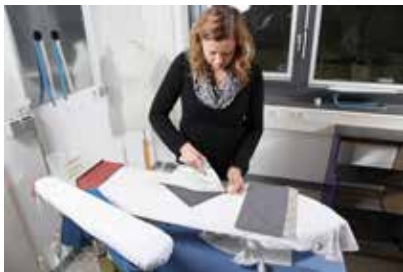
Bügeln von Stoffen, Einlagen und Nähten mit der Dampfbugelstation und Absaugtisch
