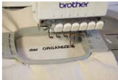
Sticken von Schriften und Mustern mit der CAD-Stickmaschine
