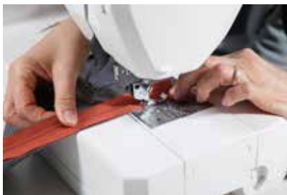
Einnähen des Reißverschlusses mit der Nähmaschine und Spezialfuß
