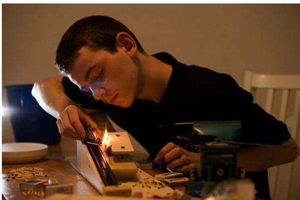
**Zündhölzer:** Welche Streichhölzer lassen sich auch bei kurzer Reibfläche noch anzünden? Johannes schuf mit Sperrholz, Modellbahnwagen und -schienen vergleichbare Bedingungen: Je nach Position der Zündholzschiene lässt sich die Länge der Reibfläche für seinen Test präzise einstellen.
