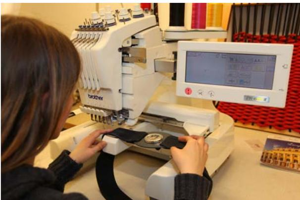
An der Computer gesteuerten Stickmaschine können Stoffgürtel mit Motiven versehen werden.
