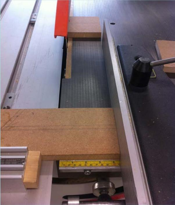
← Der MDF-Sockel wird auf das Maß 110 x 110 mm an der Kreissäge zugeschnitten.
