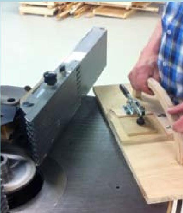
← Diese Arbeit darf nur mit Hilfe der abgebildeten Zuführung erfolgen. Die Abdeckung am Fräslinéal wurde zur besseren Sichtbarkeit entfernt.
